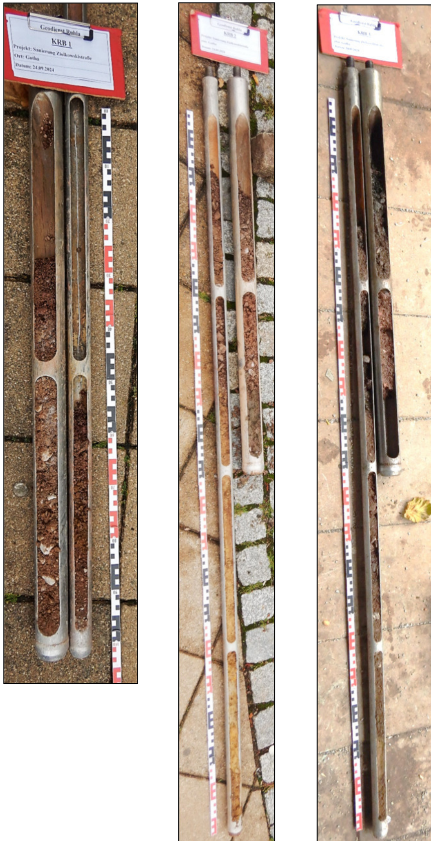
Abb.5-7: Aufschlussergebnis der Kleinrammbohrungen KRB 1 bis 3
